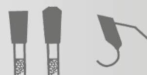
Dientes TGC bisel alterno superior para el corte de laminados
