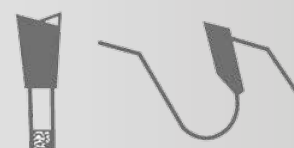
Dientes ATB bisel superior alterno
